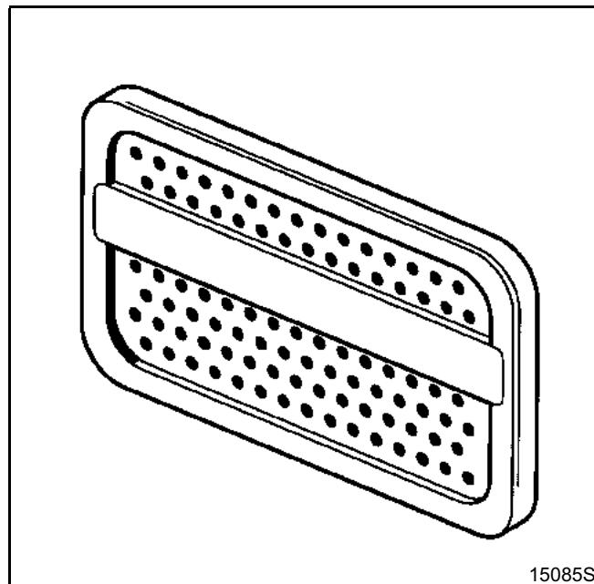
Контактная плата **Elé. 1497** представляет собой основание с 90-контактным разъемом, монолитно скрепленное с печатной платой, на которую выведено 90 омедненных и пронумерованных от 1 до 90 контактов.
