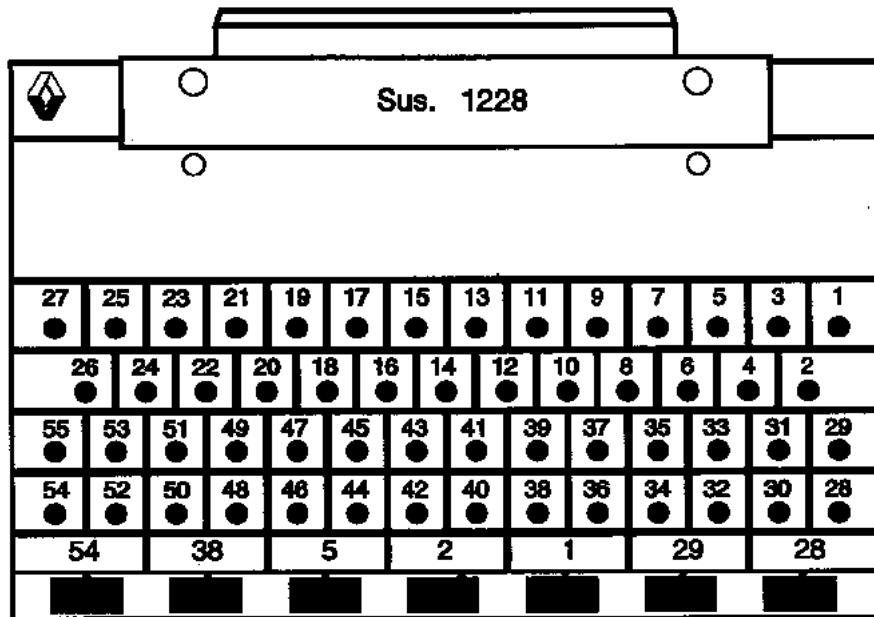
Контактная плата: **SUS. 1228** представляет собой основание с 55-контактным разъемом, монолитно скрепленное с печатной платой, на которую выведено 55 омедненных и пронумерованных от 1 до 55 контактов.
